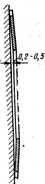
Фиг. 97. Проверка конусности дисков второго сцепления.
