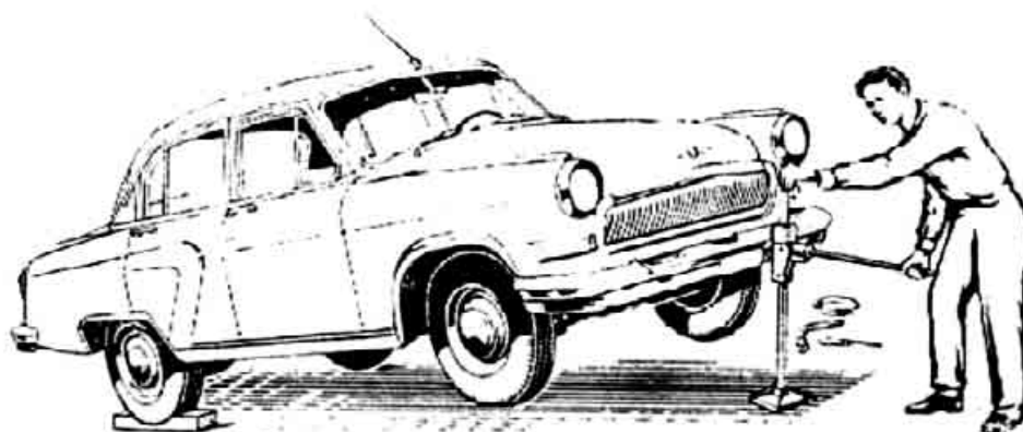
Фиг. 19. Установка домкрата
