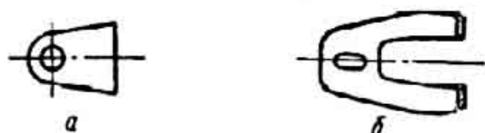
Фиг. 101. Стопор редуктора привода спидометра: а — до изменения; б — после изменения
